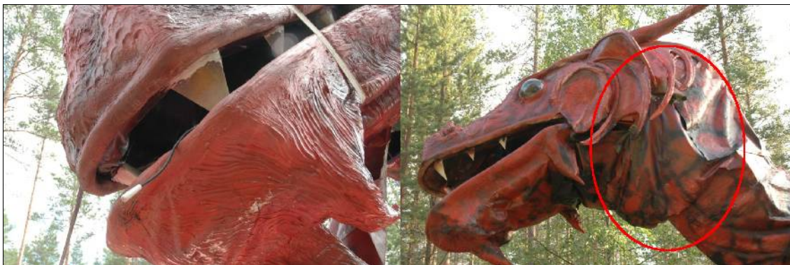
KUVIO 46. Elektreettimikrofoni roikkumassa huulesta ennen varsinaista kiinnitystään, ja kokoaluekaiuttimien paikat lohikäärmeen pään molemmin puolin ennen kidusten leikkaamista.
