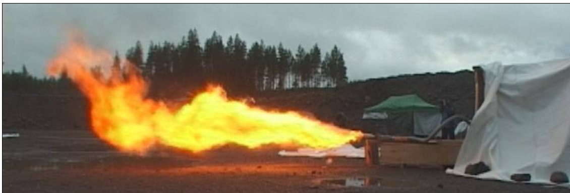
KUVIO 44. Liekinheittimen ensimmäinen prototyyppi. Puupölyä ohjataan paineella pilottiliekille, joka sytyttää pölyn tuleen.
